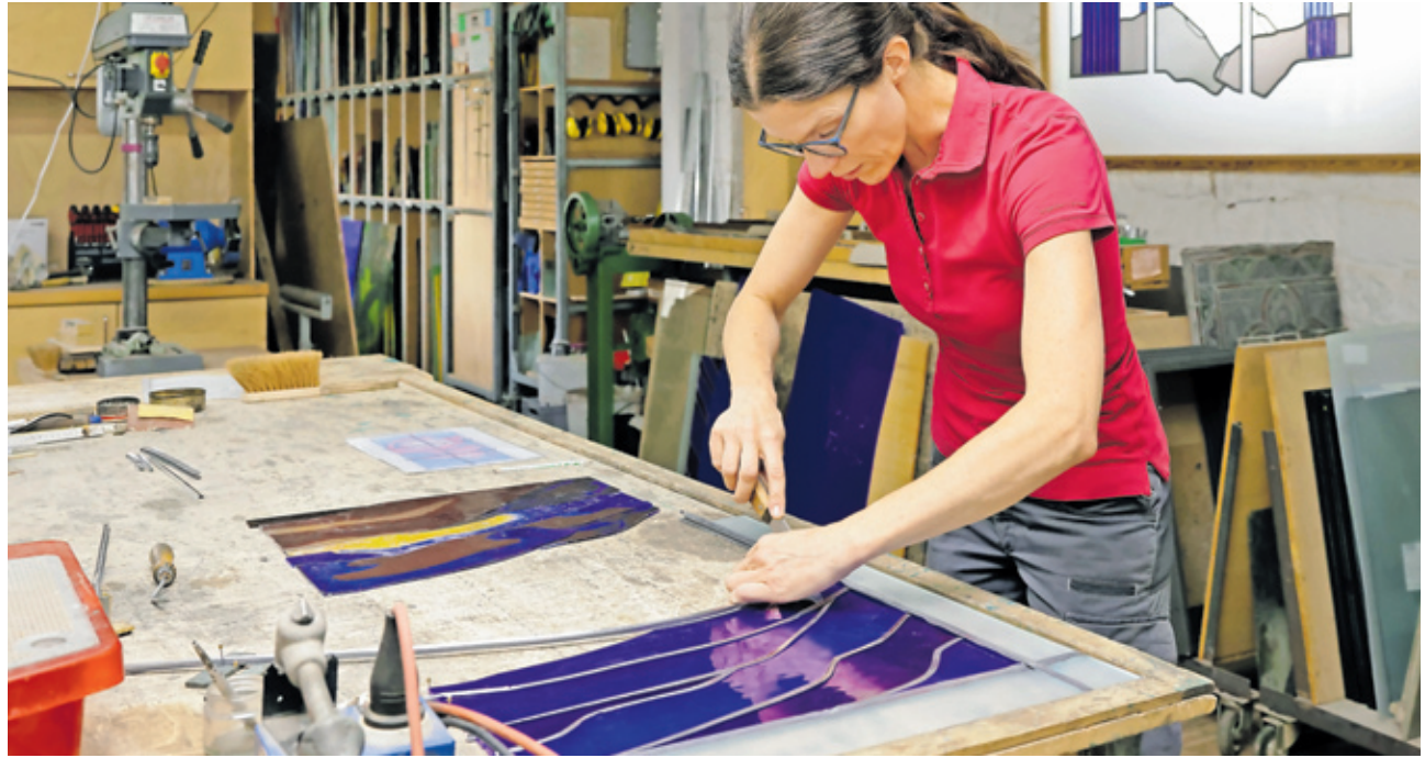
Fingerspitzengefühl: Karin Histing schneidet überschüssiges Metall ab und drückt die Bleirute an das Glas.
